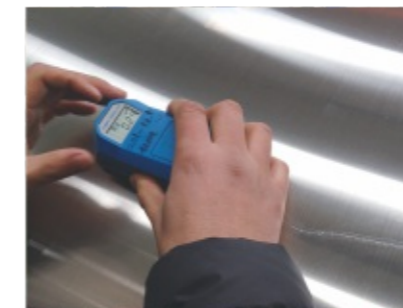
精度检测 Ra Testing
